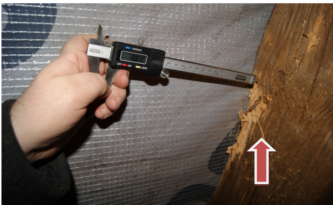
Zdjęcie Nr 13. Pomiar głębokości korozji ustroju - krokiew.
